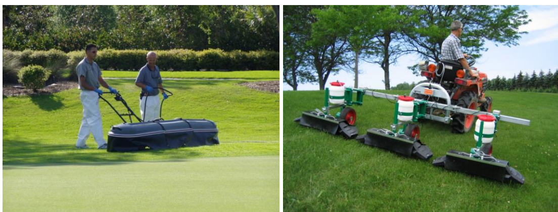
Fig. 5: Intervento di diserbo su di un green di un campo da golf effettuato con una attrezzatura dotata di copertura strisciante (a sinistra, fonte Fishel e Ferrel, 2010) ed irroratrice portata equipaggiata con coperture striscianti ed ugelli centrifughi (fonte: www.agricenter.it ).
