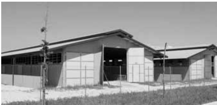
Fig. 4 Nei ricoveri la pecora da latte deve disporre di una volumetria ambientale non inferiore a 7 m 3 /capo
