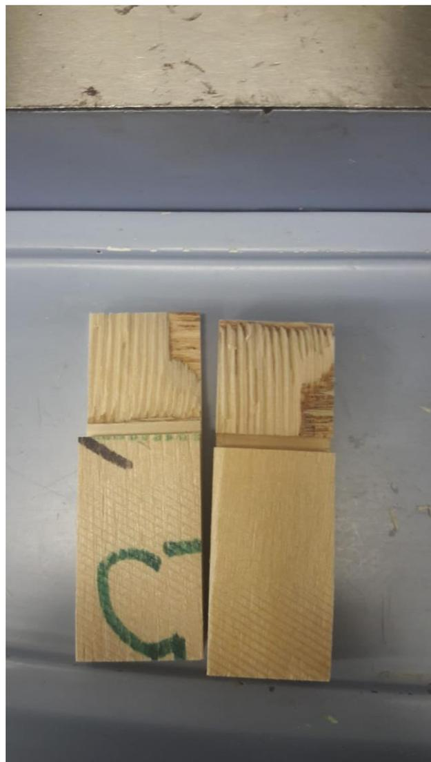
*Figura 2 - Provini di compensato post prova di trazione*
