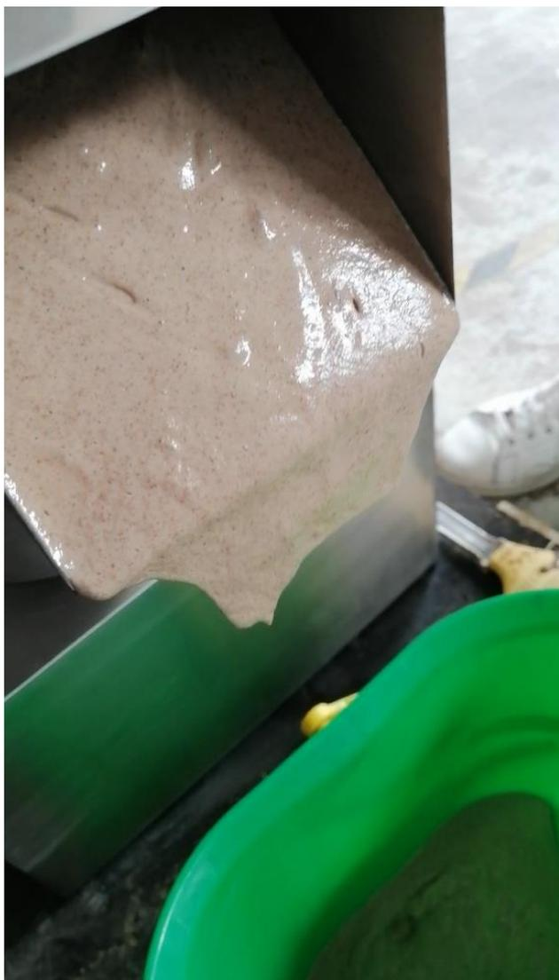
*Figura 1 - Slurry ottenuto da pannello di canapa disoleato post mulino colloidale*
