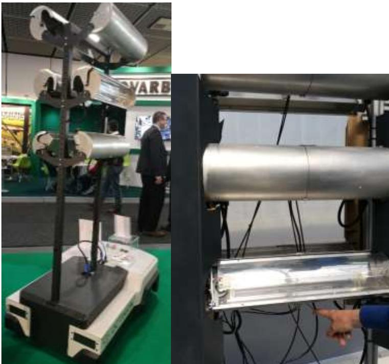
Figura 3. Sistema trainato e robot per trattamenti UV per controllo oidio e botrite in colture di fragole in pieno campo. Particolare delle lampade UV).
