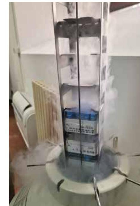
(Fig. 65) Inserimento dei campioni nella criobanca per la conservazione in azoto liquido a  $-196^{\circ}\text{C}$
