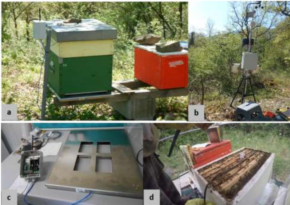
*Figura 1. Apiario con bilancia e sensori installati (a), stazione meteorologica in prossimità dell'apiario (b), bilancia pesa arnia (c), sensori umidità e temperatura posizionati internamente all'arnia (d)*
