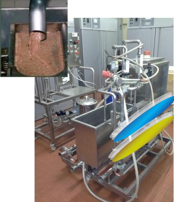
Produzione di un concentrato fenolico attraverso filtrazione tangenziale delle acque di vegetazione e sua ulteriore purificazione (estratto fenolico).
