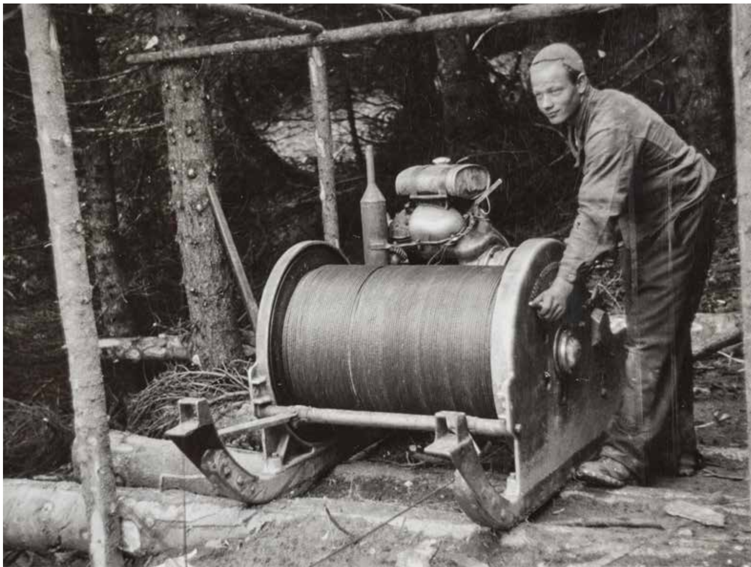
Il meccanico, che ha già messo in moto il motore del verricello, regola l'ascesa del legname frenando la traente (s.l., 1949)
