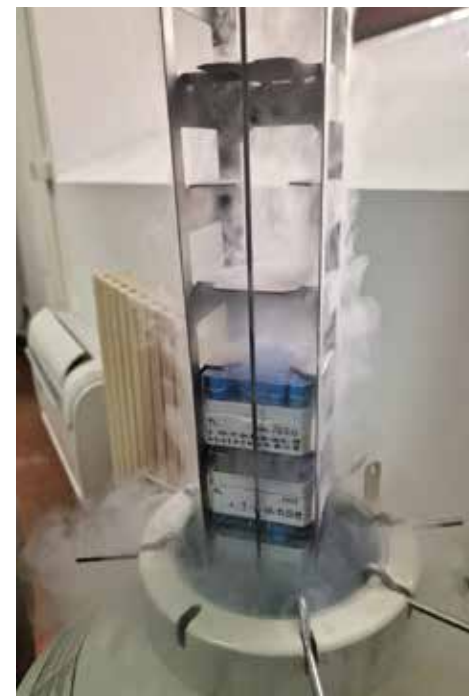
(Fig. 65) Inserimento dei campioni nella criobanca per la conservazione in azoto liquido a -196°C
