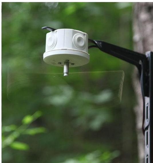
Figura 2 - Trappola captaspore posizionata in vivaio per intercettare spore e propaguli di inoculo di patogeni vegetali.
