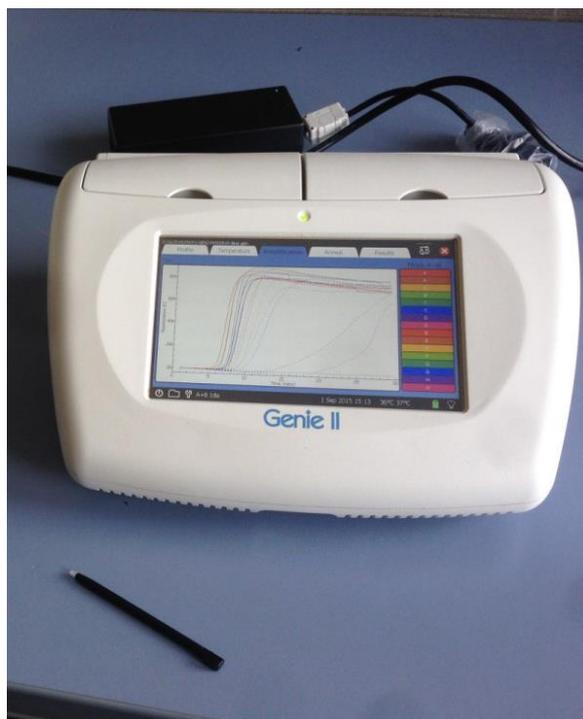
Figura 1 - Strumento portatile che utilizza la tecnica LAMP per rilevare patogeni direttamente in campo.
