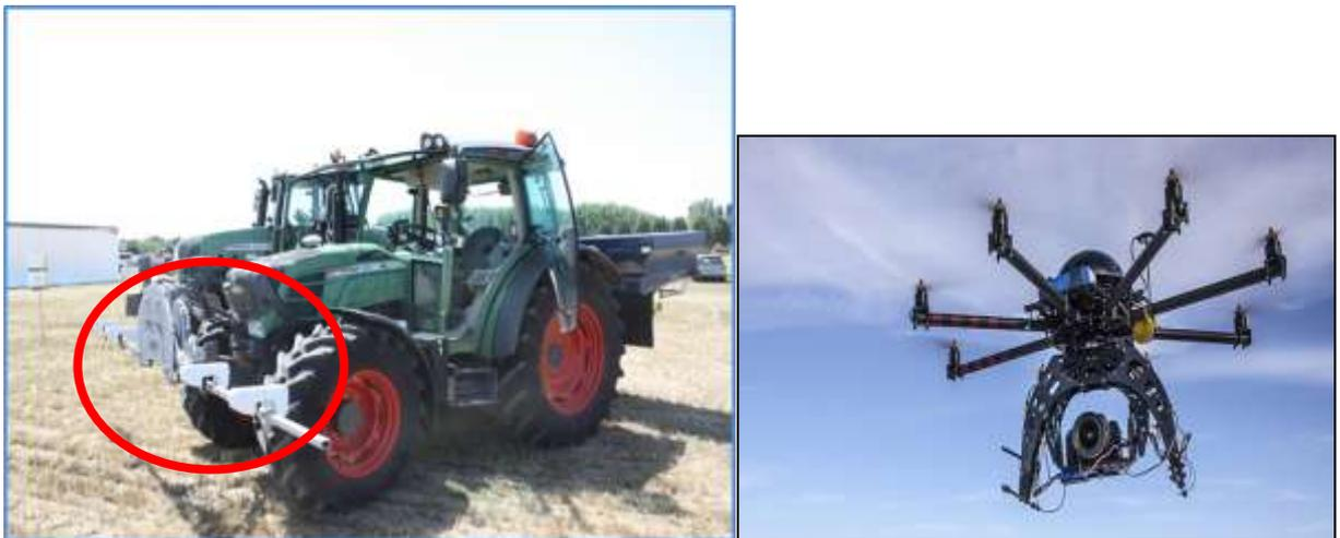
Figura 2 – Sensori montati sul frontale della trattoria (proximal sensing) oppure su droni (remote sensing).
