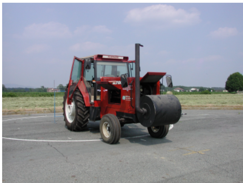
Figura 2. Trattrice insonorizzata utilizzata per l'esecuzione delle prove di acustica. Durante le acquisizioni le cofanature vengono chiuse.
