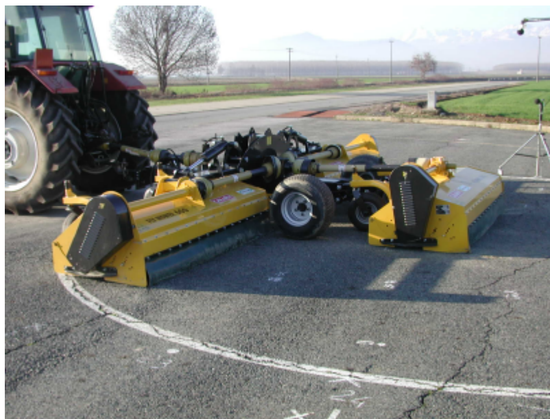
Figura 1. Trinciatrice ad asse orizzontale durante i rilievi acustici.
