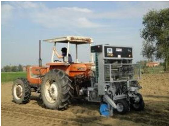
Fig. 5: trapiantatrice a comando elettronico.
