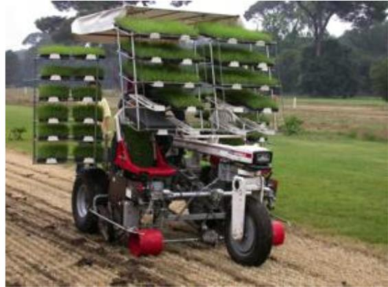
Fig. 4: trapiantatrice idraulica.
