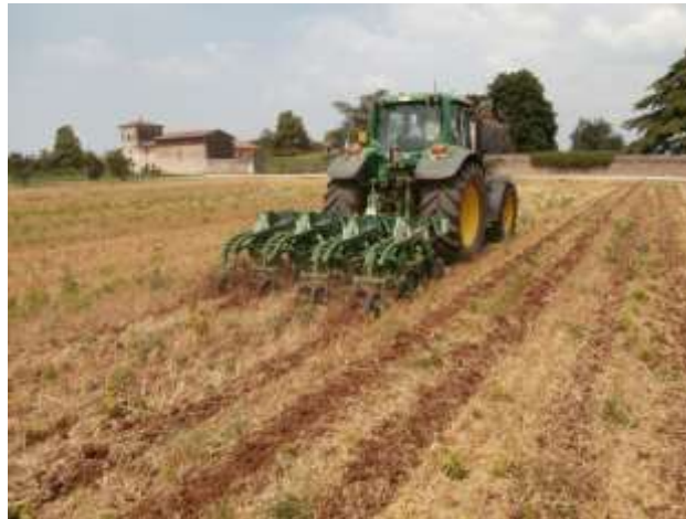
Fig. 1 – Lo strip tillage si avvantaggia dei ricevitori satellitari e dei sistemi di guida semi-automatici ad alta accuratezza perché prevede ripetuti passaggi sempre sullo stesso percorso
