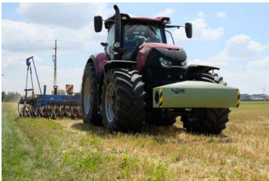
Fig. 2 – I sensori geoelettrici ad induzione elettromagnetica riescono ad individuare anche gli strati di terreno a diversa densità. Alcuni di questi, compatibili con l'Isobus del trattore, sono in grado di comunicare in tempo reale con la macchina operatrice (foto Geoprospectors).
