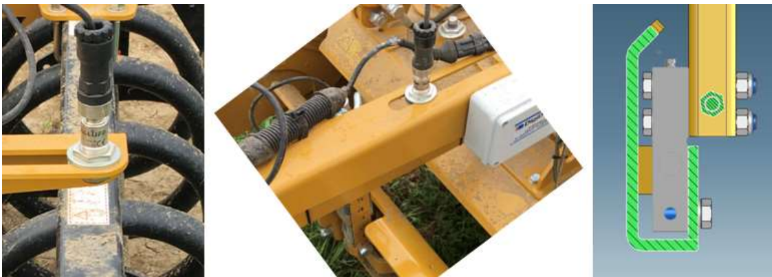
Fig. 3 – I sensori applicabili sull'erpice rotante per aumentarne la sensibilità: nell'ordine sensore ultrasonico per il rullo e per la barra e cella di carico applicata sulla barra livellatrice.
