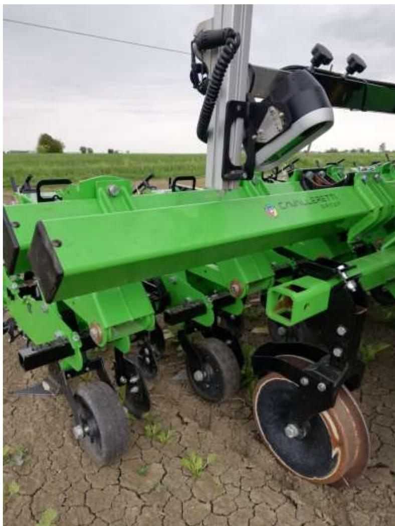
Foto 1 e 2 - Sarchiatrice a riconoscimento visivo delle file per una migliore precisione e operatività di lavoro, munita di elementi rotanti in grado di interagire sulle file. Utilizzata in conduzione biologica della bietola, può fornire ottimi risultati anche in coltivazione tradizionale, a integrazione della gestione delle malerbe per una maggior sostenibilità e riduzione dell'impatto ambientale.
